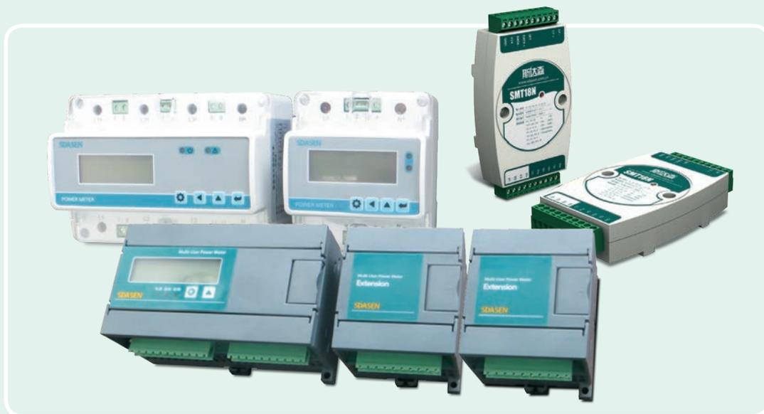
SMT 系列智能电力导轨表是针对电力系统、工矿企业、公共设施、智能大厦的电力监控、能耗分析、能源管理等需求而设计的高精度、高可靠性、高性价比的智能电力仪表产品。它能测量所有的常用交流电力参数，包括相电流、电压、有功 / 无功功率、频率、电度、功率因素、谐波等。并且可选配最大需量、分时段 / 区间计量、复费率电度量统计、电能脉冲计数、事件记录、越限告警等功能。
